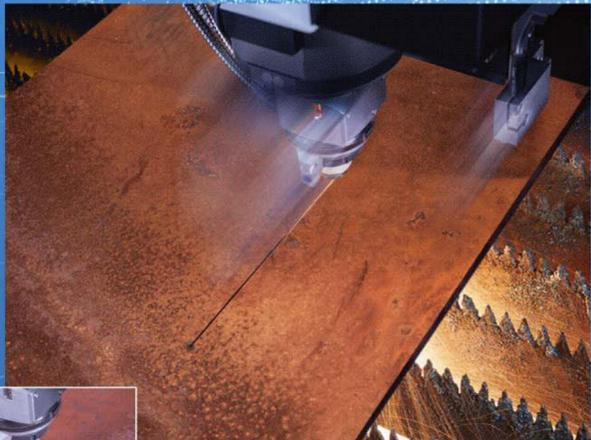
▲ 表面が錆びた材料でも安定した切断が可能
